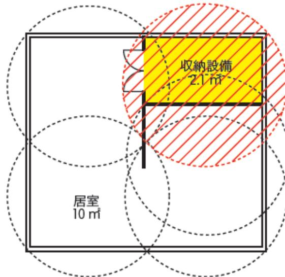
○ パッケージ型自動消火設備Ⅱ型による消火剤の有効放射範囲      ● 住宅用下方放出型自動消火装置による消火剤の有効放射範囲
