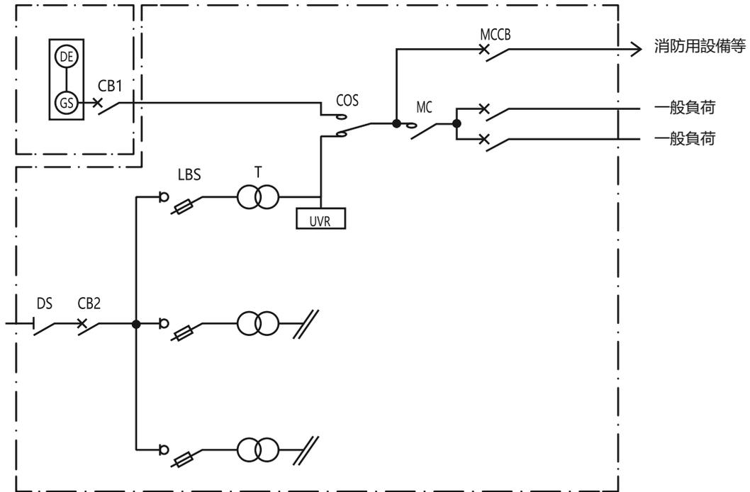
(注) UVRは、変圧器の二次側から自動切替装置までの間に設けること。
