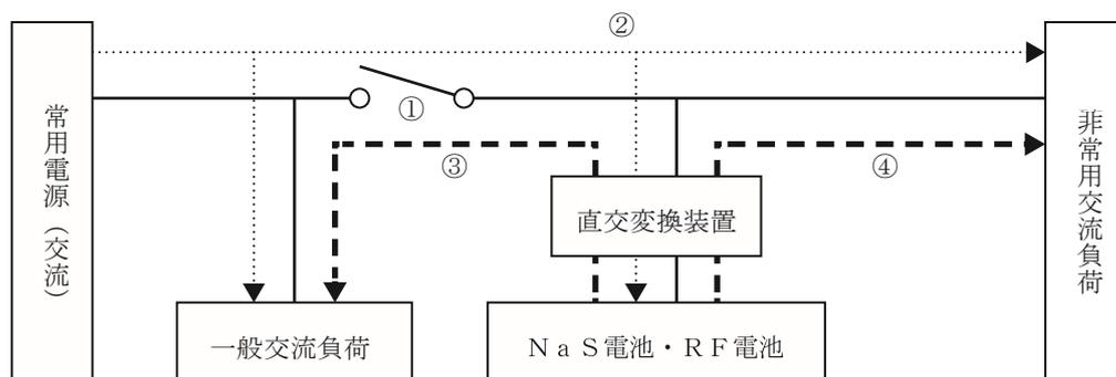
(注) 1 Na S 電池及び RF 電池は、電力負荷平準化（電気料金の安い夜間に充電を行い、昼間に放電を行うこと）を目的として、一般的に常用電源と非常電源を兼用とすることを想定している。
