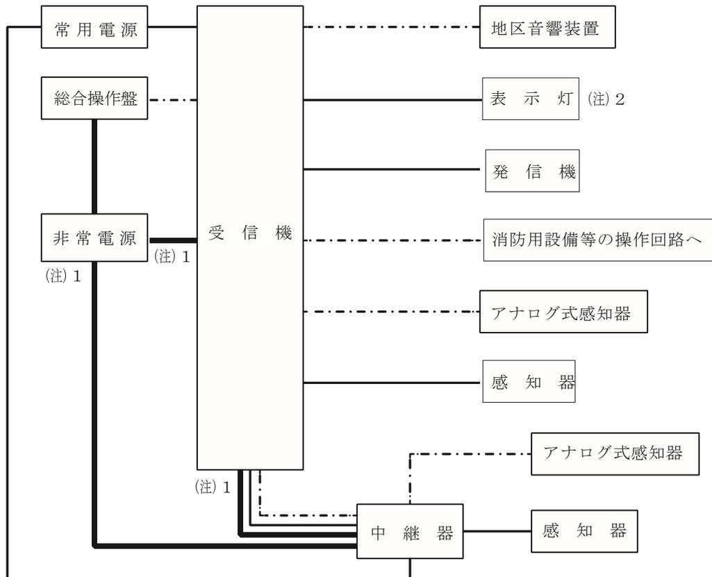
(注) 1 中継器の非常電源回路（受信機又は中継器が予備電源を内蔵している場合は一般配線である。）
