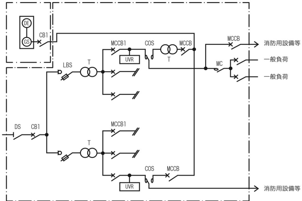
(注) UVRは、MCCB1から自動切替装置までの間に設けること。
