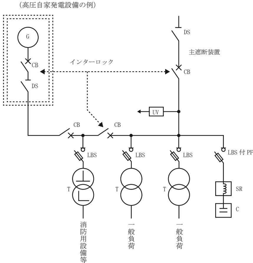
**UV** : 不足電圧継電器等は、主遮断装置の負荷側の位置とし、上位の主遮断装置と適切なインターロックをとること。
